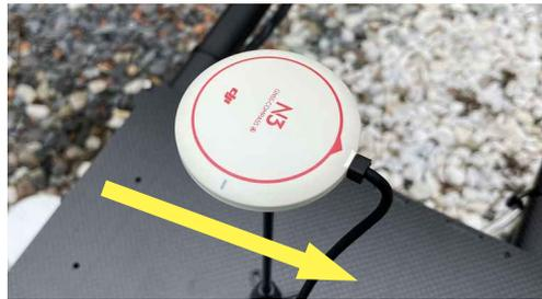
アンテナの矢印を機体の前方に合わせる
